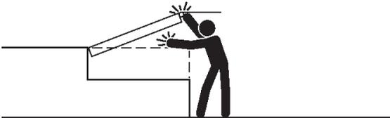
Tenir les mains et les pieds à l'écart des points de pincement. Éviter de placer une quelconque partie du corps à proximité de pièces en mouvement.
